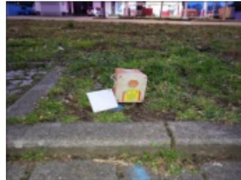
Dies sind Sensoren (Geophone) von den Vibrationsmessungen (Vulcan Vibro Trucks).
